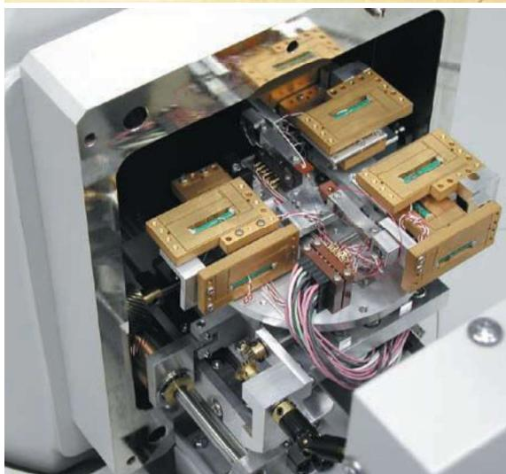
2001年3月に完成した、半導体故障解析に特化したマイクロマニピュレータ（写真上）。電子顕微鏡に組み込んで使う（写真下）。
